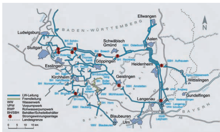
Abb. 1 Die Anlagen der Landeswasserversorgung
